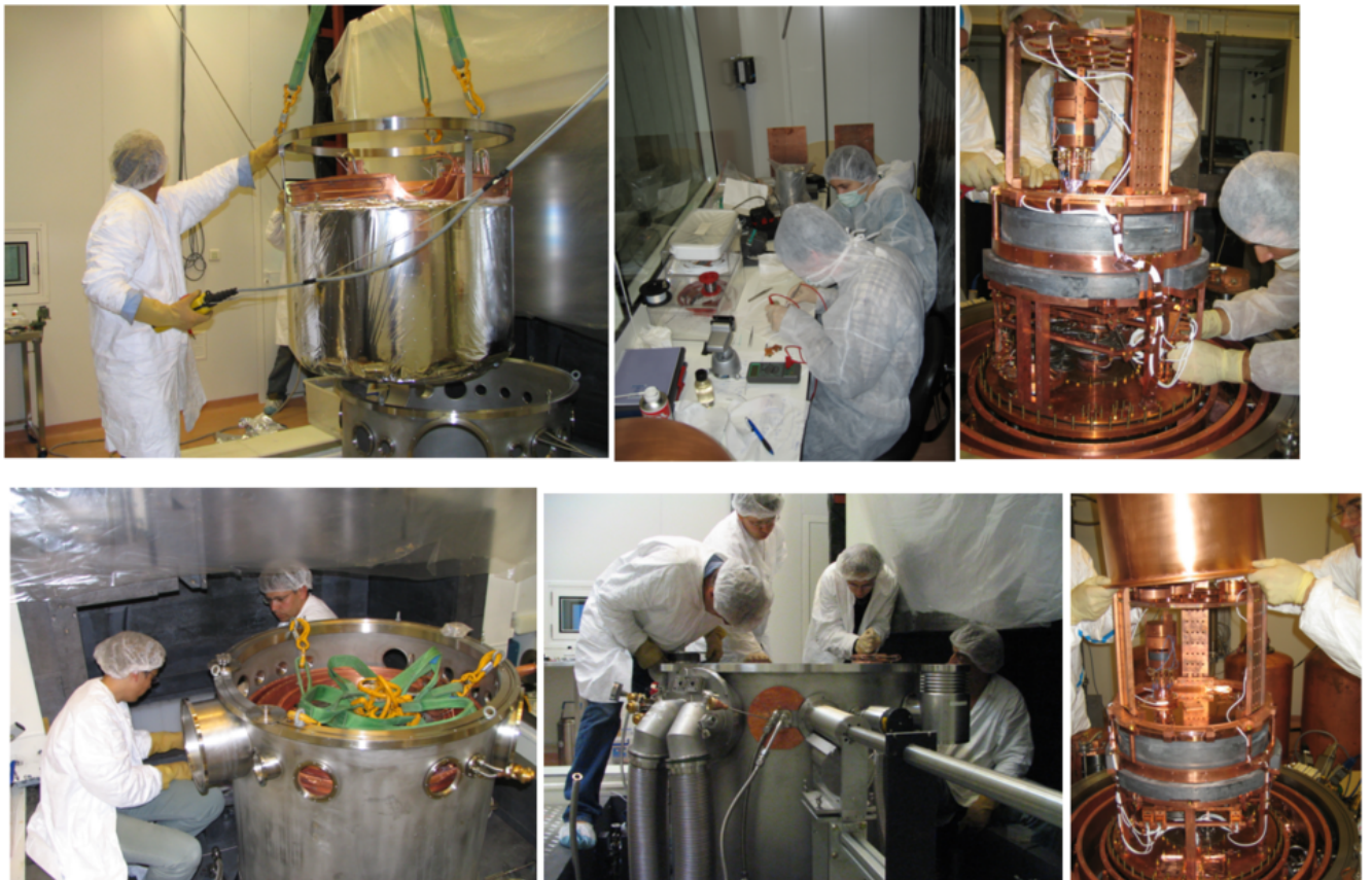
Рис. 4.6. Фотографии сборки криостата EDELWEISS с участием соискателя.
